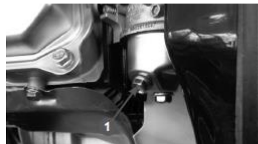
СЛИВ ТОПЛИВА ИЗ КАРБЮРАТОРА 1. Болт сливной
