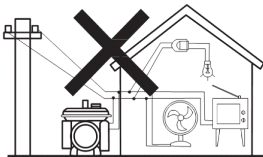
Рис. 10 Неправильное подключение генератора к промышленной электрической сети — без блокировок
