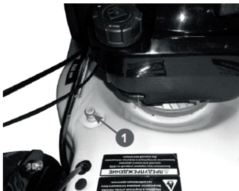
Рис. 27 Расположение коннектора для подключения шланга А - коннектор
