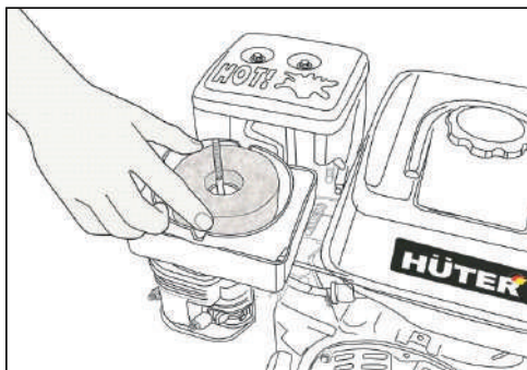
Установка воздушного фильтра
