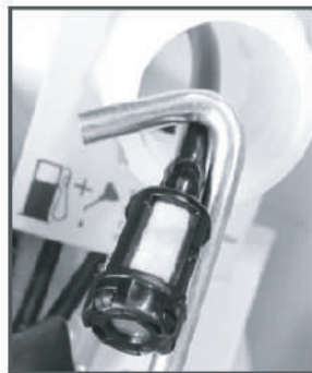
Рис. 9 Извлечение топливного фильтра
