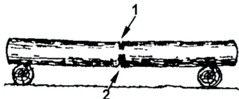
Рис. 10 / Fig. 10 Пропилы при раскряжке дерева на двух опорах / Cuts for wood splitting on two supports
