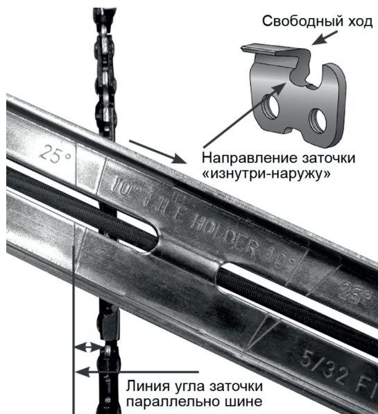
Рис. 14 / Fig. 14 Определение угла заточки / Determination of the sharpening angle
