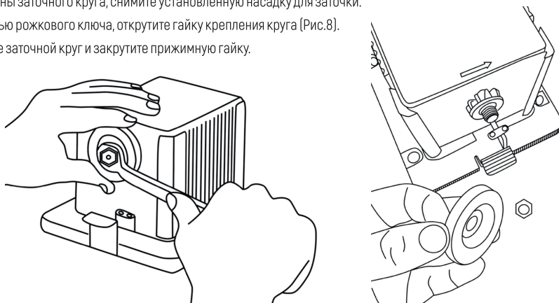
Рис.8 Замена заточного круга
